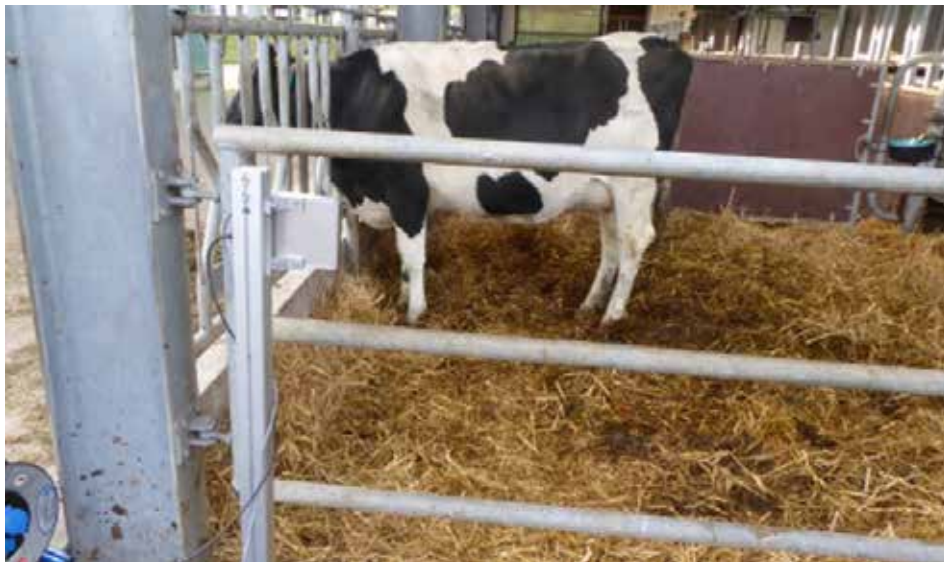
Medición sin contactos de frecuencia cardíaca y respiratoria con radar
